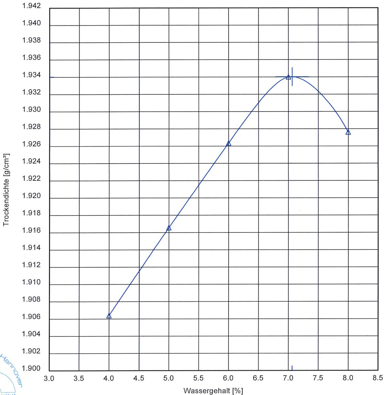
100 % der Proctordichte  $\rho_{Pr} = 1.934 \text{ g/cm}^3$
